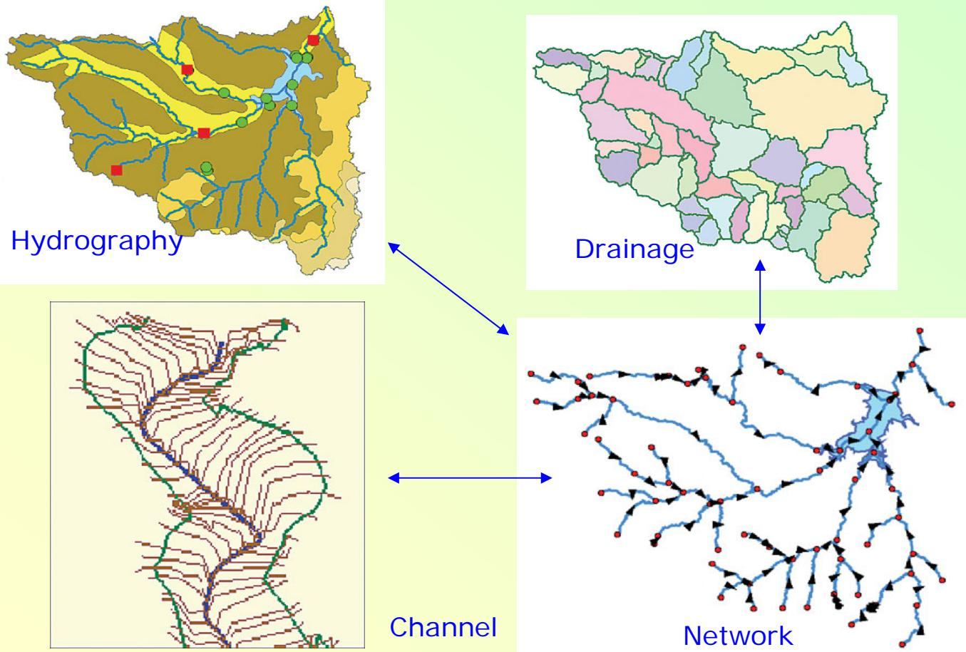
En TWINLATIN - ArcHydro se ha implementado. ArcHydro conecta datos hidrológicos con modelos de calidad de agua y sistemas de apoyo a la toma de decisiones
