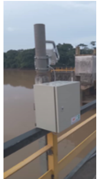
Capteur de niveau d'eau sur barrage hydroélectricité
